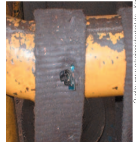
Bild 4-4: Durch heißen Span beschädigte Oberfläche
