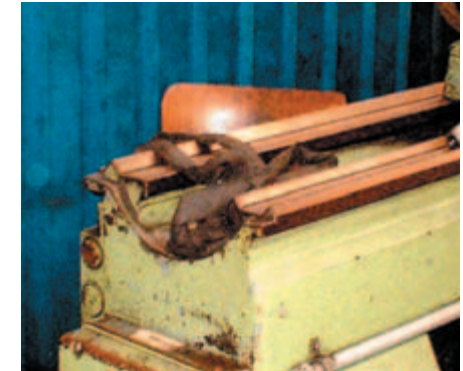
Bild 5-2: Ungünstige Lagerung von Anschlagmitteln, Beispiel 2
