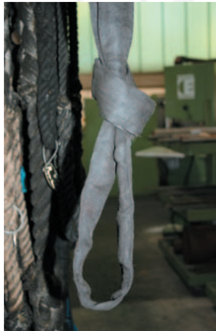
Bild 1-3: Unzulässiger Knoten in einer Rundschlinge
