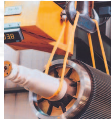
Bild 1-11: Sicheres Anschlagen langer Lasten
