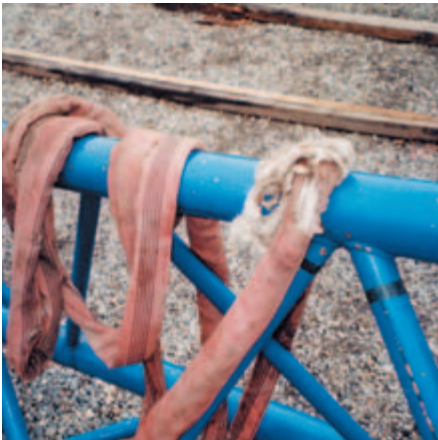
Bild 4-5: Starke Beschädigung der Ummantelung und der Einlage
