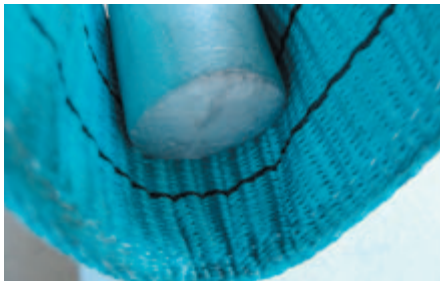
Bild 1-8: Unzulässige Auflage der Last im Hebeband
