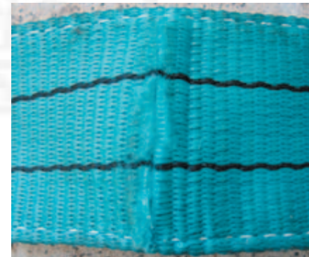
Bild 4-1: Unzulässiger Einschnitt an der Oberfläche
