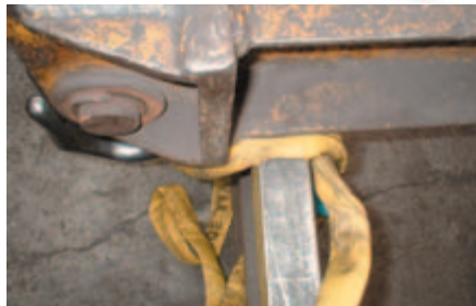
Bild 1-9: Beschädigung einer Rundschlinge durch darauf abgesetzte Traverse
