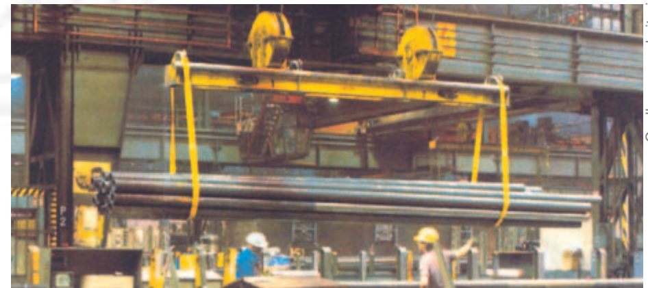
Bild 1-11: Sicheres Anschlagen langer Lasten
